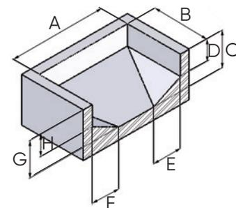
Les rayons horizontaux doivent être inférieurs ou égaux à 15 cm, les pans coupés inférieurs ou égaux à 10 cm.
