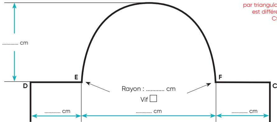
Nous vous préconisons d'utiliser le bon de commande de prise de cotes par triangulation dès lors que la cote EF est différente de 2 fois la profondeur. Cf. bon de commande p. 145.
