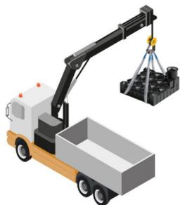
Déchargement et mise en fouille sur lit de pose avec un moyen de manutention approprié.
