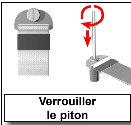
La sangle doit être tendue et le tablier doit toucher le dessous du passe-sangle
