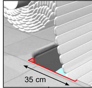
*Si besoin, disquer les margelles pour faciliter le passage du tablier et éviter les frottements*
