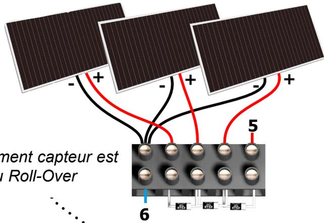
Le domino de raccordement capteur est fixé à l'intérieur du Roll-Over
