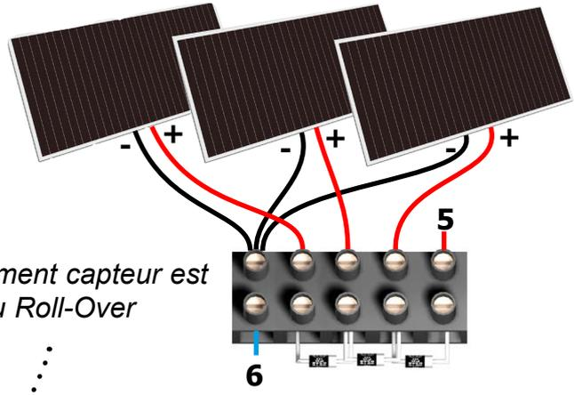
Le domino de raccordement capteur est fixé à l'intérieur du Roll-Over
