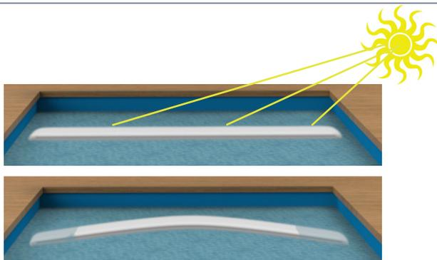
Lorsque le tablier est sous le soleil, il peut arriver que les lames se déforment à cause de la chaleur.
